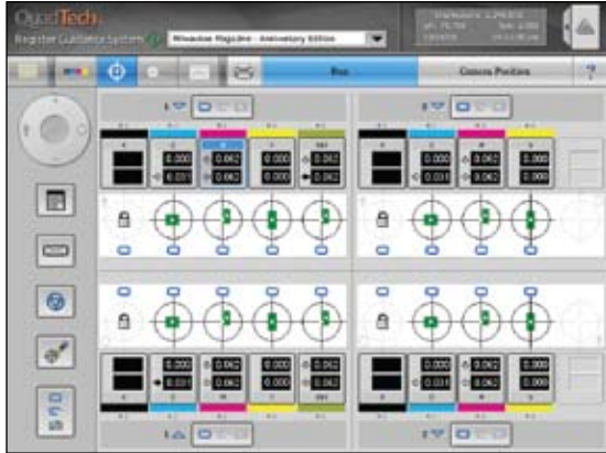
Экран системы приводки красок - печать коммерческих тиражей
